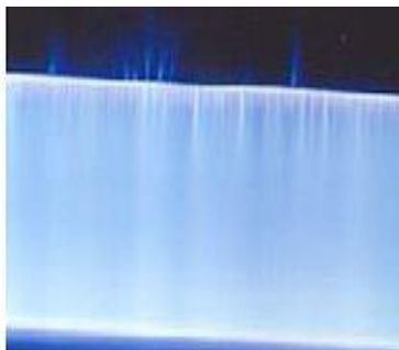
б) электрод айналасында пайда болған тәжі разрядтын
