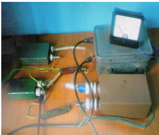
3.3-сурет. Жоғарғы кернеуге түрлендіруге арналған генератордың электрлік сұлбасы (а) мен фотосуреті (б)
