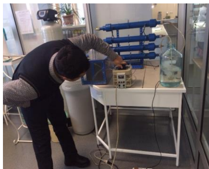
3.15-сурет. “Астана Су Арнасы” Электрлі тәжі разрядка негізделген озонатор қондырғысы арқылы ауыз суды залалсыздандыру тәжірибе жұмыстары
