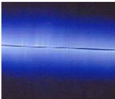
б) электрод айналасында пайда болған тәжі разрядтын
