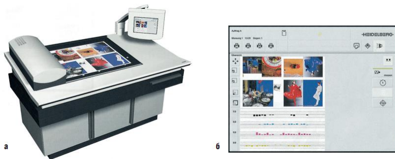
Рис. 9.6. Измерительная и регулировочная система для измерения цвета и проверки изображения на печатном листе: а - измерительное устройство; б - показания на дисплее (Heidelberg)
