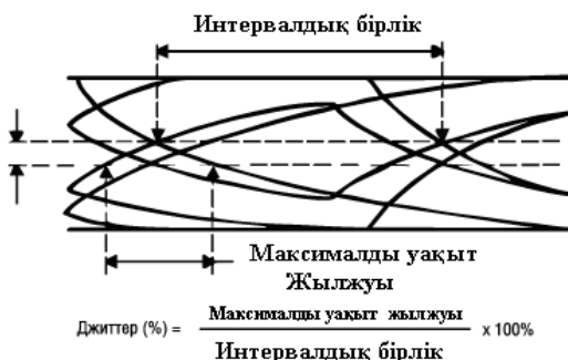
8.5-сурет. Джиттер (Jitter) және оны өлшеу
