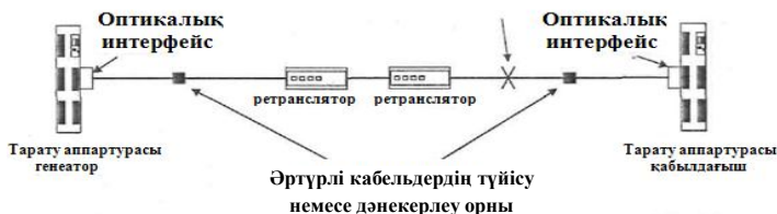
3.1-сурет. Талшықты-оптикалық байланыс желісінің типтік сұлбасы
