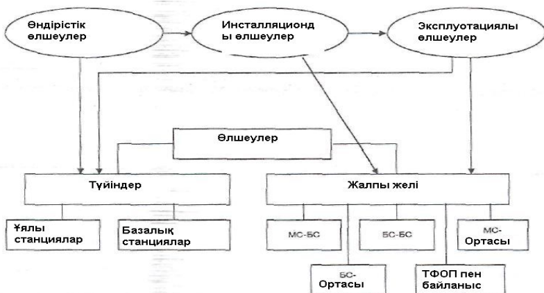
13.1-сурет. Жылжымалы радиобайланыс желілеріндегі өлшеудің жалпы сұлбасы
