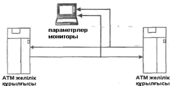
12.1-сурет. Сапалы параметрлерді өлшеудің пассивті мониторингтік сұлбасы
