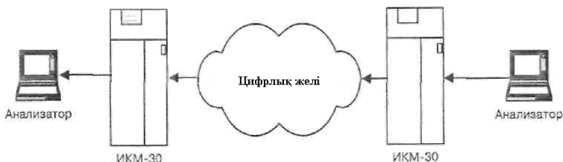
7.10-сурет. "Нүкте-нүкте" типтегі берілістің сандық жүйесі арналарының параметрлерін өлшеу сұлбасы
