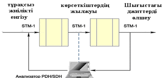
8.2-сурет. Желідегі рассинхронизацияны өтеуді бақылау
