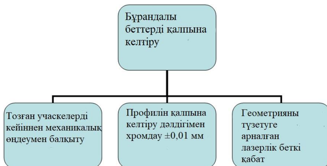
2-сурет – Бұрандалы беттерді қалпына келтіру әдістері
