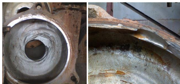
5-сурет – 8Гр-8 тереңдету сорғысының гильзасының тозуы
