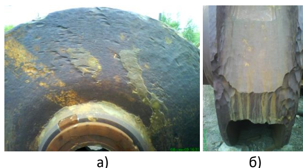
2-сурет – 2Гр 8000/71 сорғы импеллерінің қирау сипаты: а – импелль дискінің сыртқы беті (кавитациялық тозу); б – импеллердің (сұжабық тозуы) сауда нүктесінің жиектерінің беттері
