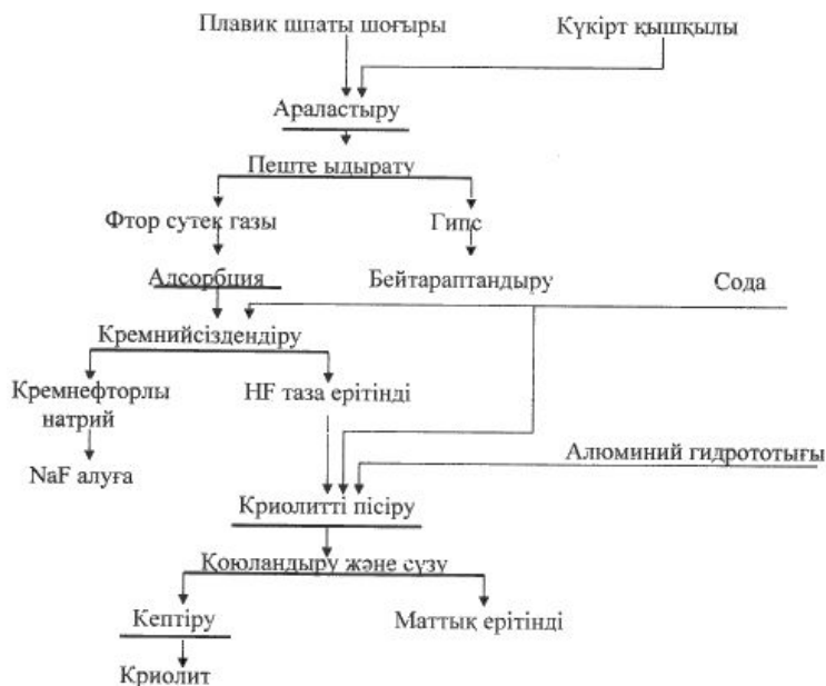
24-сурет. Қышқыл әдіспен криолит алу схемасы
