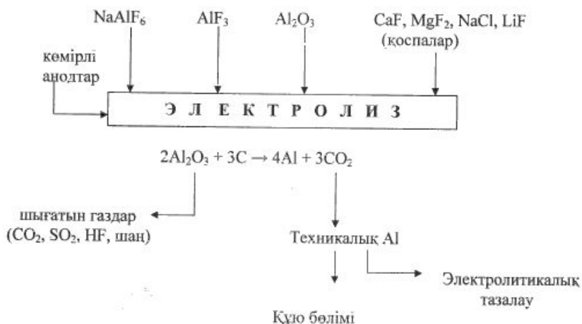
28-сурет. Криолит сазбалшық балқымасынан электролизбен алюминий алу өндірісінің технологиялық схемасы
