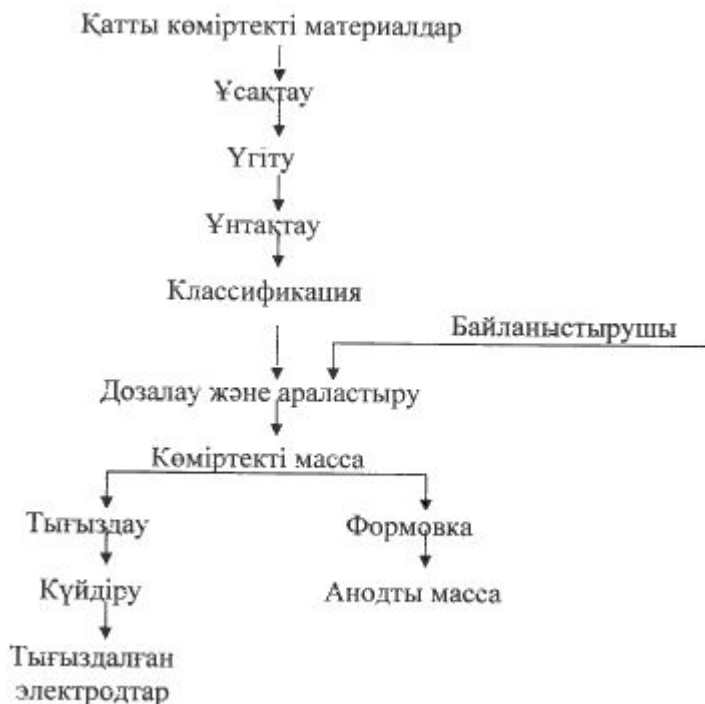
23-сурет. Электрод бұйымдар өндірісінің схемасы
