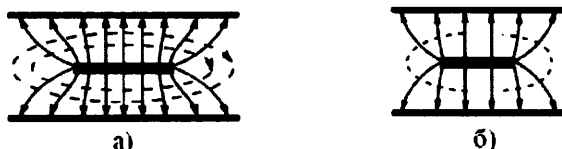
Рис. 3.23. Структура поля волны в полосковой линии:
