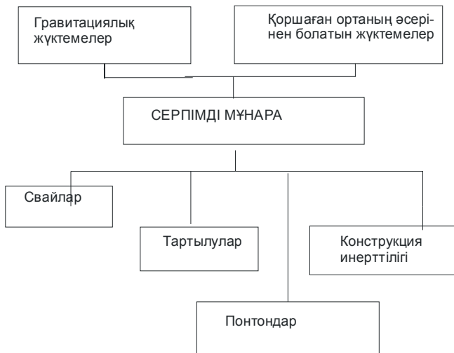
3.19-сурет. Серпімді мұнаралардың конструкция элементтеріне жүктемелерді тарату сұлбасы
