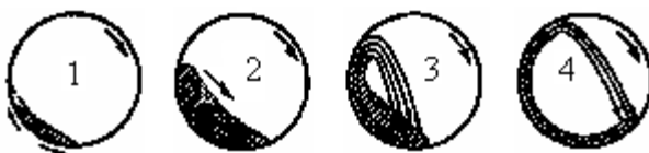
1.22-сурет. Айналмалы барабанның көлденең қимасымен сусымалы материалдың қозғалысы
