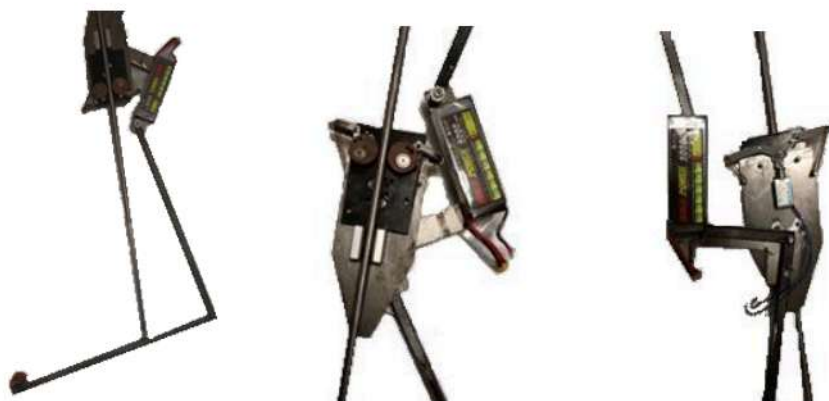
Рисунок 9 – Устройство фиксации высоты ноги по сигналу датчика контакта стопы с опорной поверхностью
