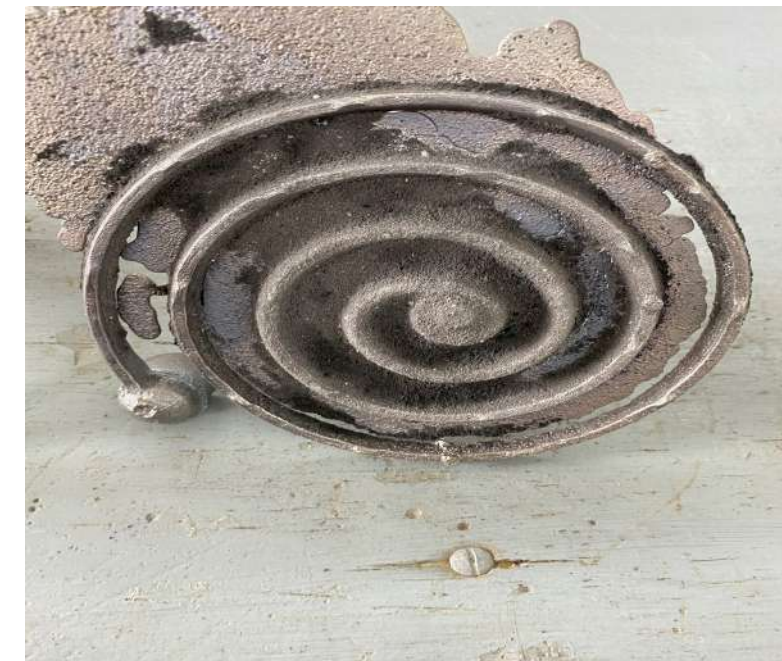
Рисунок 6 – Проба на жидкотекучесть плавки 4 серии
