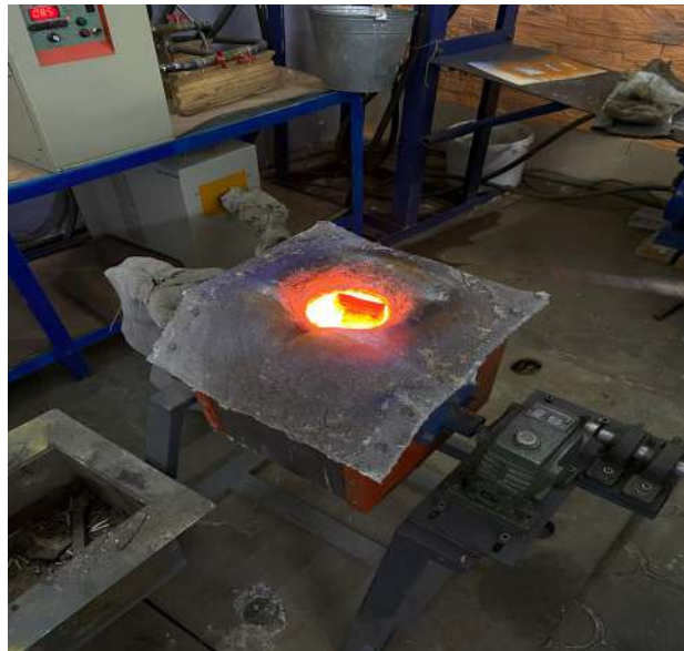
Рисунок 1 – Процесс плавления чугуна в индукционной электропечи GW-MF-25
