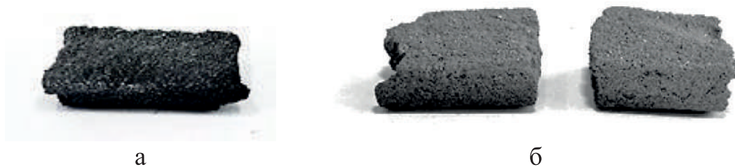
Рисунок 3 – Внешний вид губчатого железа, полученного восстановлением при температуре: а) 900 °С, б) 1000 °С
