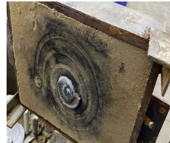
Рисунок 5 – Жидкотекучесть чугуна, полученного в первой серии плавов
