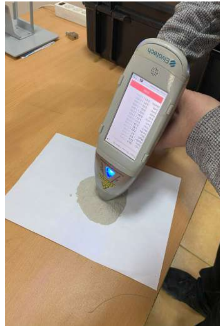
Рисунок 2 – Портативный рентгено-флуоресцентный анализатор химического состава материалов
