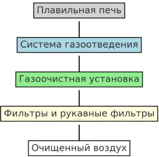
Рисунок 1 – Принципиальная схема системы газоочистки на ферросплавных предприятиях
