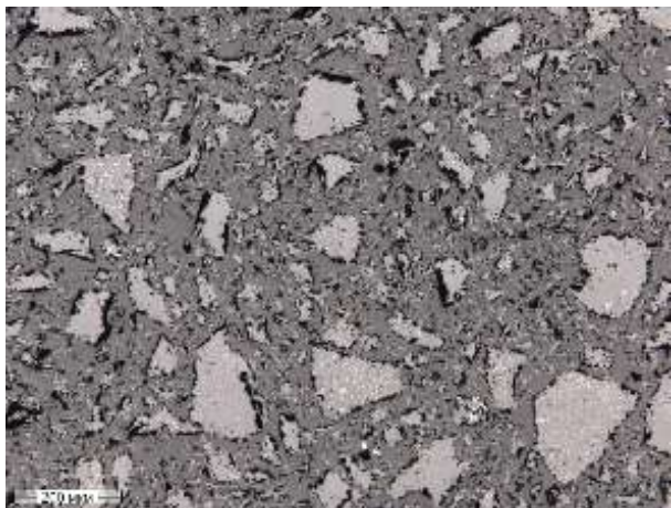
Рисунок 2 – Оптический снимок свинцового шлака, полученный при увеличении x100
