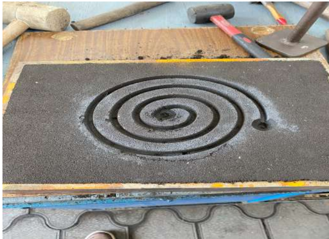
Рисунок 4 – Литейная форма для определения жидкотекучести чугуна
