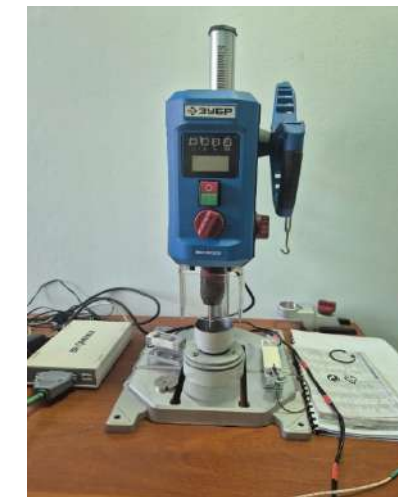
Рисунок 1 – Универсальная машина трения УМТ-200
