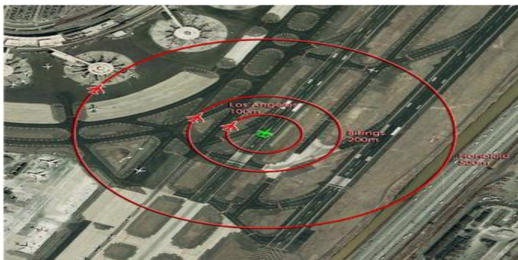
Рисунок 1 - Неотмеченный маневр в апреле 2007 г. вызвал ошибки эфемерид на одном спутнике GPS. Эта эфемеридная ошибка вызвала зависящие от местоположения ошибки определения местоположения до 500 м на приемниках без возможности обнаружения
