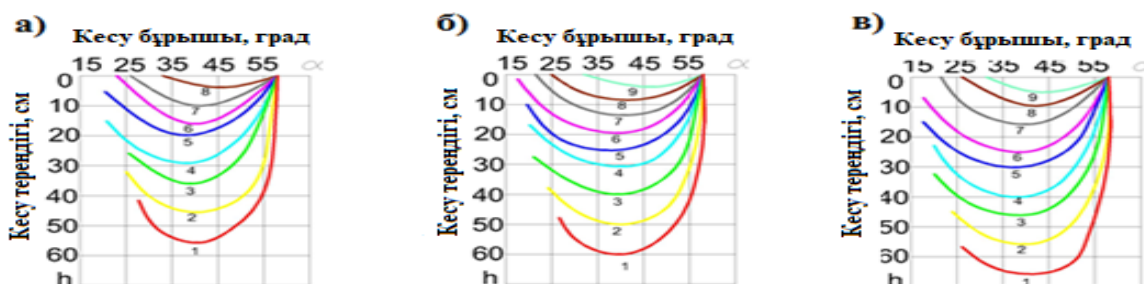
4 сурет - Топсалы қиманы бекіту координаттары өзгерген кезде кесу бұрышы мен тереңдігінің байланысы: а, б, в - қозғалтқыш жақтауының бүйіріндегі бекіту нүктелері, сәйкесінше 5' , 6' және 7' ; 1,2,3,4,5,6,7,8 және 9 - қайырма күректегі бекіту нүктелері
