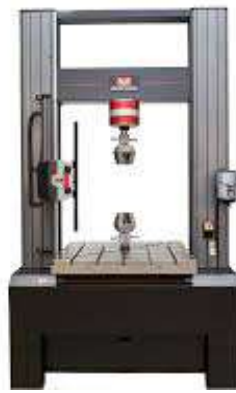
5-сурет – Механикалық қасиеттерін анықтауға арналған қондырғының жалпы түрі INSTRON-100
