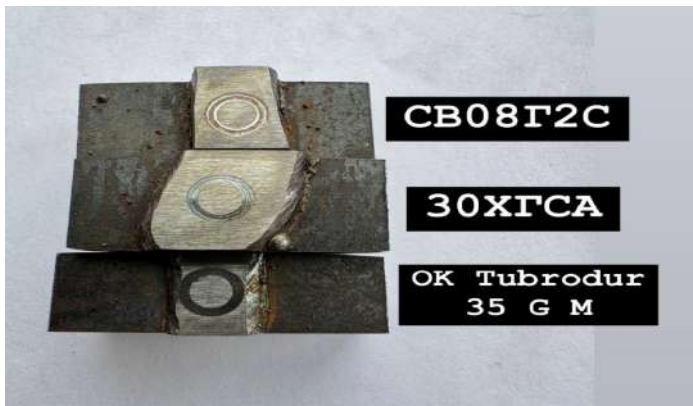
Рисунок 5 – Образцы после трибологических испытаний
