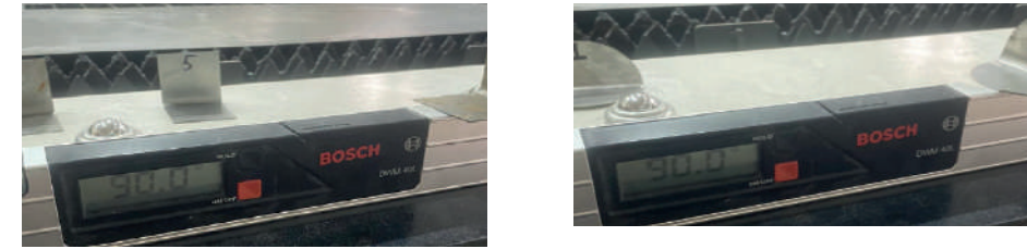
Рисунок 8 – Измерение угла заготовок с использованием оборудования для измерения угла после гибки: а) Заготовка размером 100x50 мм, толщиной 0,8 мм; б) Заготовка диаметром 81 мм, толщиной 1 мм
