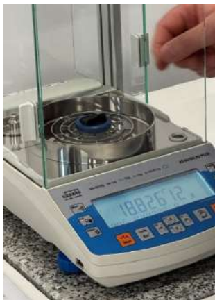
Рисунок 4 – Лабораторные весы AS 60/220.R2 PLUS Analytical Balance
