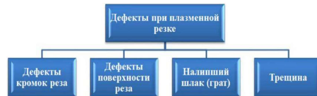
Рисунок 1 – Виды дефектов при плазменной резке
