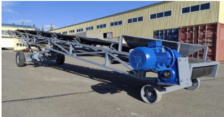
Рисунок 11 – Экспериментальные транспортер с углом наклона боковых роликов \alpha_p = 30^\circ .
