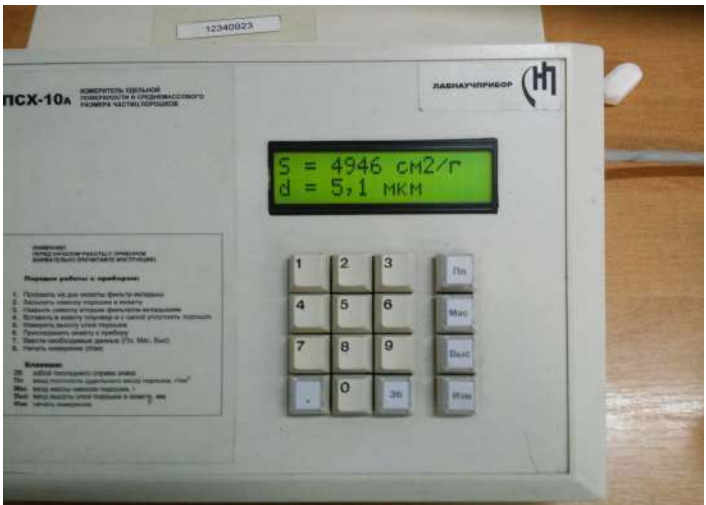
Рисунок 8 – Измерение удельной поверхности с помощью прибора ПСХ-10
