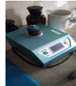
7-сурет – 04315M маркасының газ өткізгіштігін анықтауға арналған аспап
