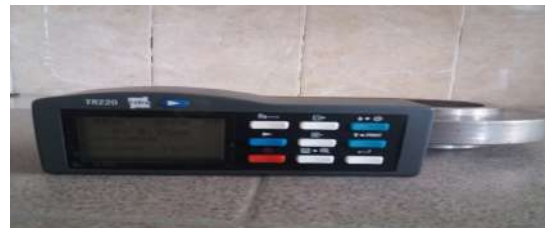
6-сурет – Кедір-бұдырлықты өлшеуге арналған аспап TR-220
