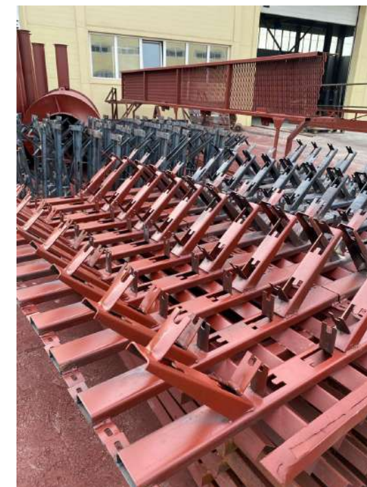
Рисунок 8 – Экспериментальные роликовая опора желобчатая с рамой
