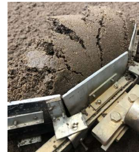
Рисунок 3 – Бульдозерное оборудование с изменяемым углом резания и разноуровневым изменением геометрии
