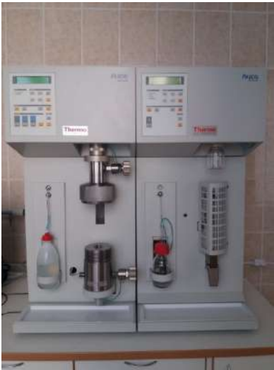
8-сурет – PASCAL 400 жүйесінің порозиметрі
