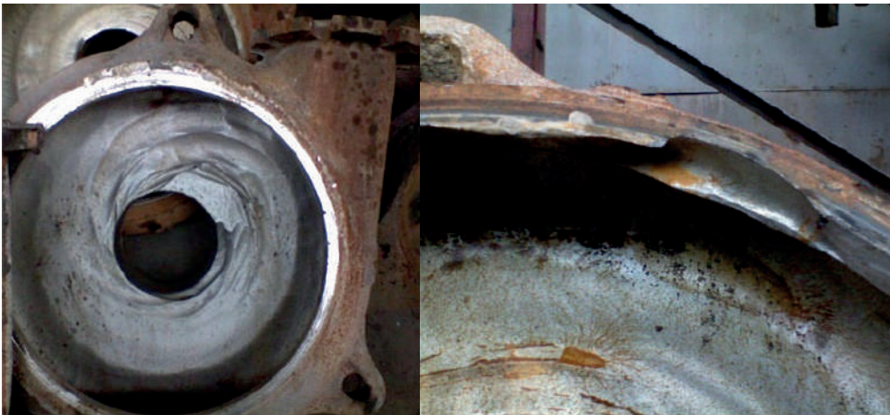
Сурет 3 – 8ГР-8 топырақ сорғысының корпусының тозуы
