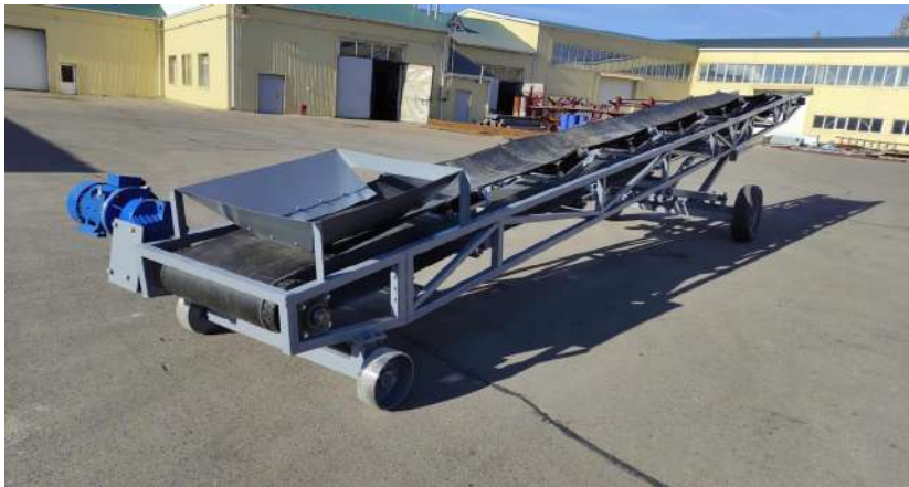
Рисунок 10 – Экспериментальные транспортер с углом наклона боковых роликов \alpha_p = 20^\circ .
