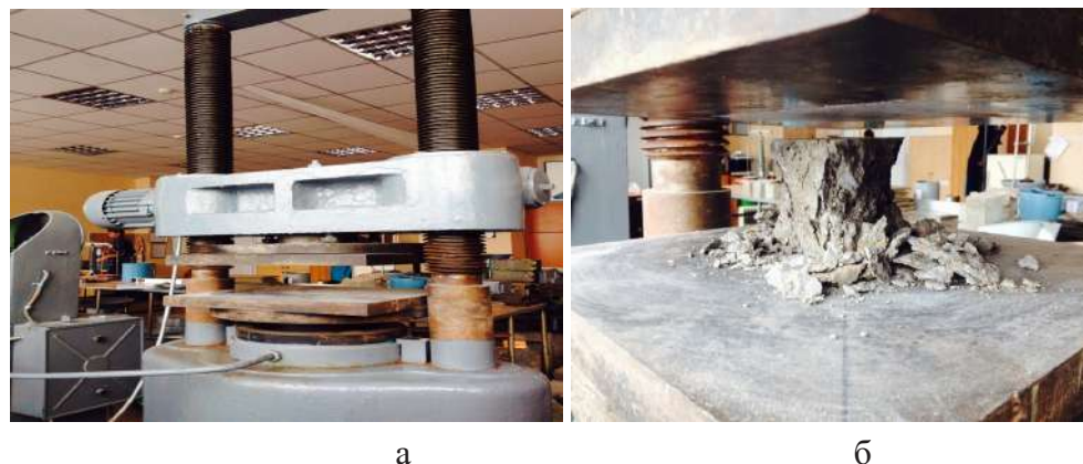
Рисунок 4 – Испытания на гидравлическом прессе
