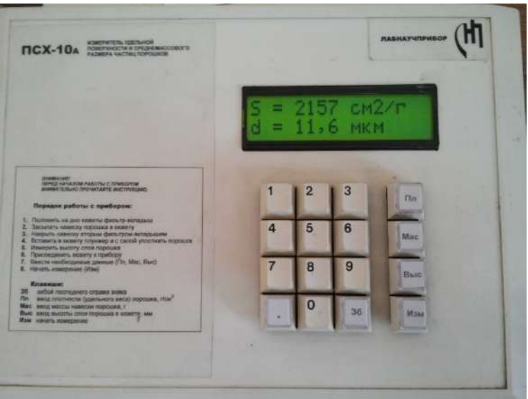
Рисунок 6 – Прибор ПСХ-10 для измерения удельной поверхности и среднего размера частиц
