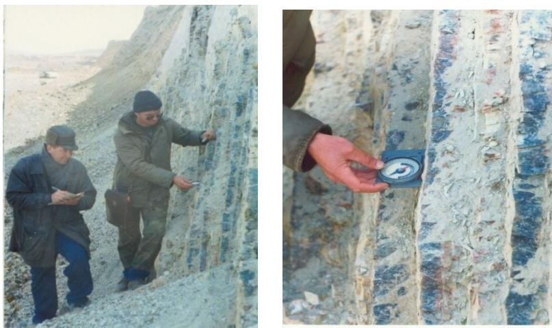
Рис. 5.8. Съёмка трещиноватости горного массива на карьерах
