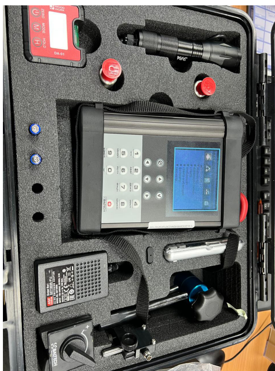
5-сурет – BALTECH VP-3470 діріл анализаторы
