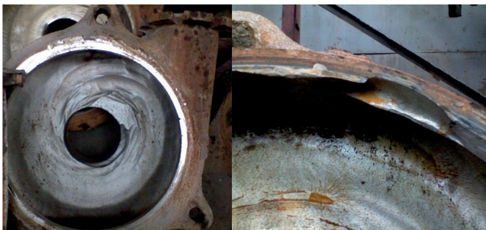
Сурет 3 – 8ГР-8 топырақ сорғысының корпусының тозуы
