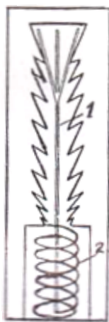
1.6-сурет. Ломоносовтың автоматты реттеуіші:
