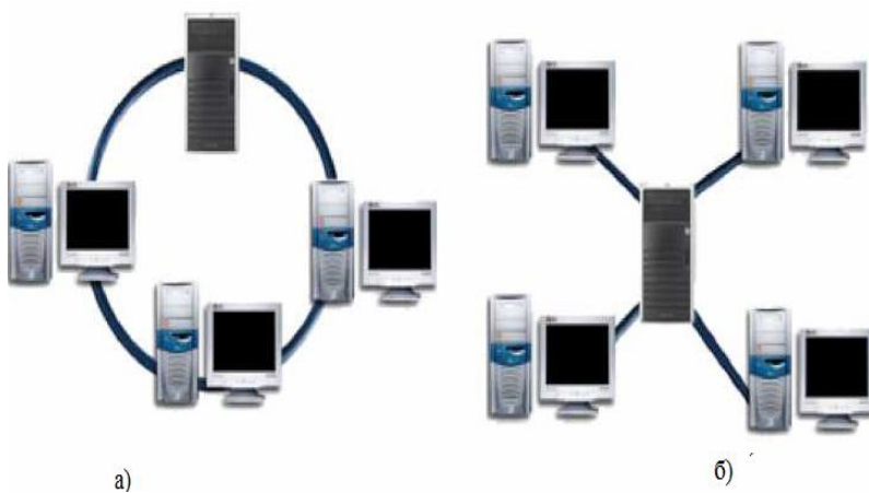
Рис. 2.4. Типовые топологии: а) топология «Кольцо»; б) топология «Звезда»
