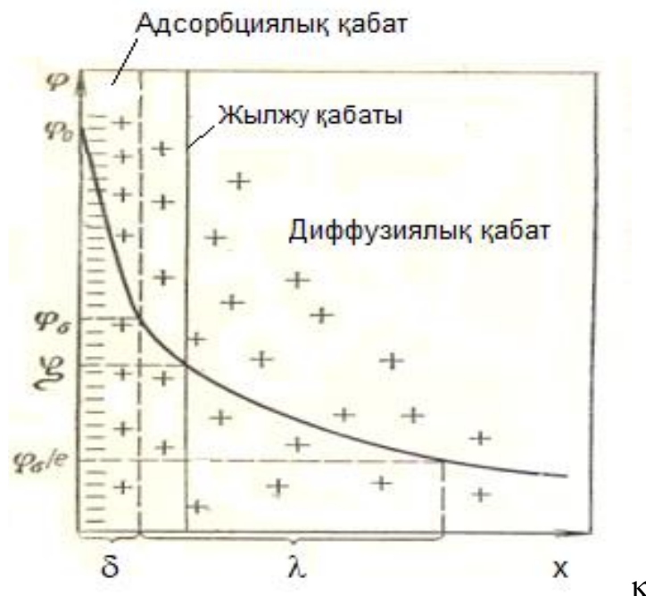
14.4-сурет. Штерн теориясы бойынша ҚЭЖ-тың құрылысы
