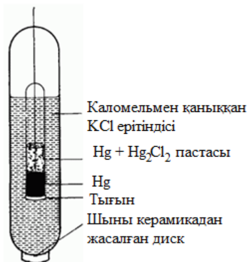
14.6-сурет. Каломель электродының сызба-нұсқасы
