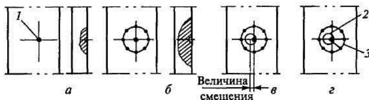
Рис. 53. Сверление отверстий по разметке
