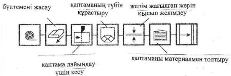
7.35-сурет. Каптама жасау машинасының сұлбасы
