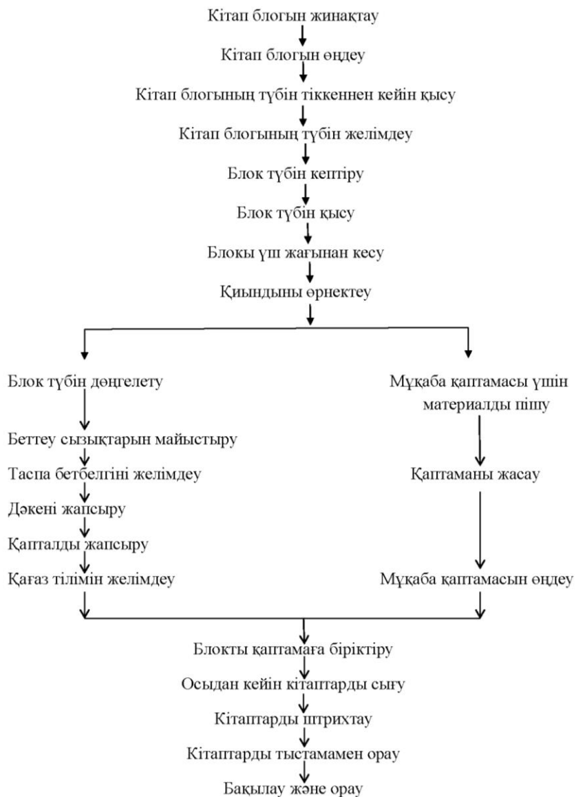
7.1-сурет. Түптеу процестерінің жалпы технологиялық сұлбасы
