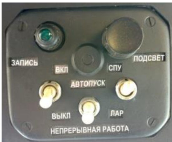
Фото 4. Пульт управления МС-61Б
