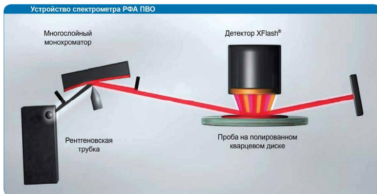
46-сурет. S2PICOFOX спектрометрінің РФА ПВО құрылғысы
