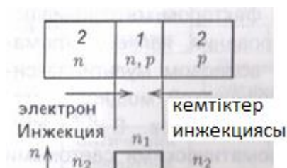
4.6-сурет. Қос гетеро құрылымның қос сызбалық суреті
