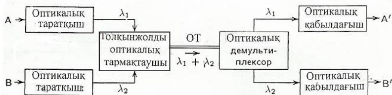
2.11-сурет. Оптикалық сигналдарды толқындық мультиплексерлеудің сұлбасы
