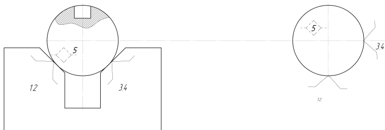
Рис. 1.11. Схема базирования цилиндра на призме
