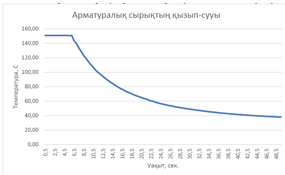
Сурет 3 – Арматуралық сырықтың қызып-суу диаграммасы бар.
