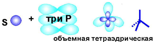
Рис. 1.7. Образование гибридной sp^3 -орбитали и, соответственно, тетраэдрической структуры кристалла (типа алмаз)
