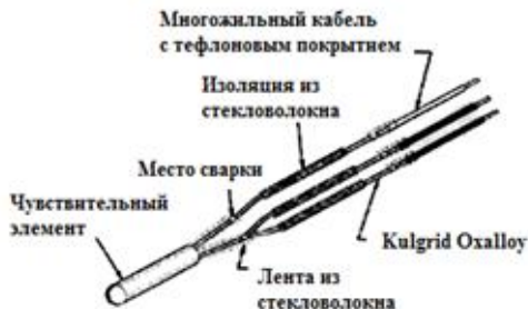
Рис. 2.6. Примерная схема сборки чувствительного элемента термометра сопротивления
