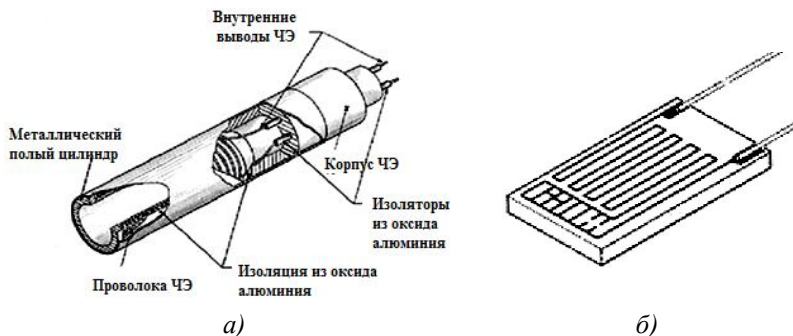
Рис. 2.5. Примерные схемы чувствительных элементов конструкций «hollowannulus» (а) и «thin-film» (б) термометра сопротивления
