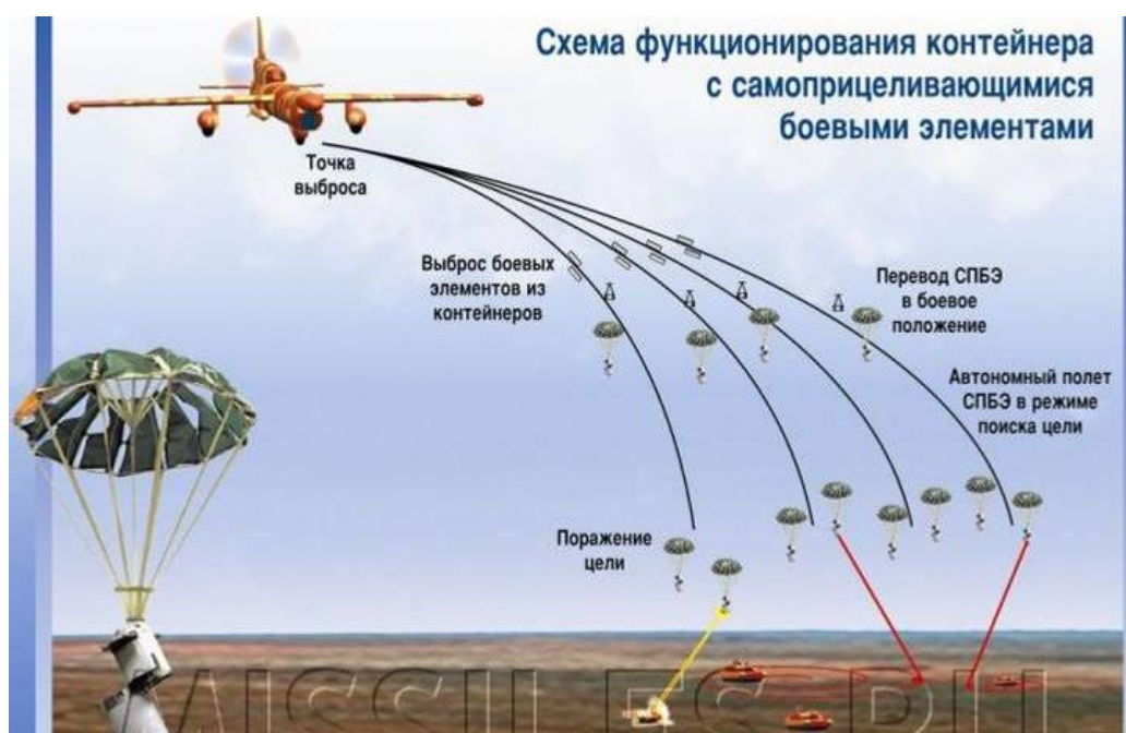
Рис. 2.27. Принцип действия самоприцеливающихся суббоеприпасов
