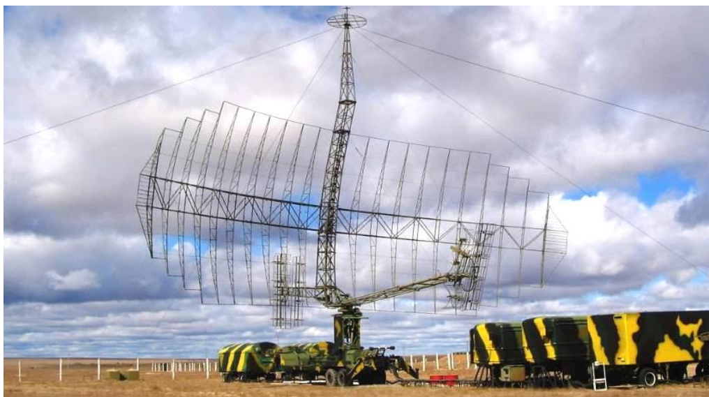
Рис. 3.3. Радиолокационная станция 5Н84 «Оборона»
