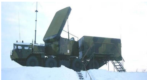
Рис. 1.23. Радиолокатор подсвета и наведения ЗРС С-300ПС
