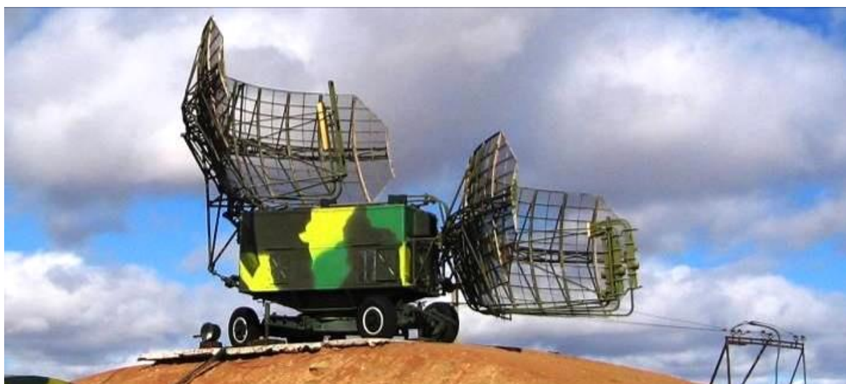
Рис. 3.5. Радиолокационная станция П-37
