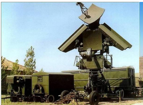
Рис. 1.19. Радиолокационная станция наведения ракет СНР-125
