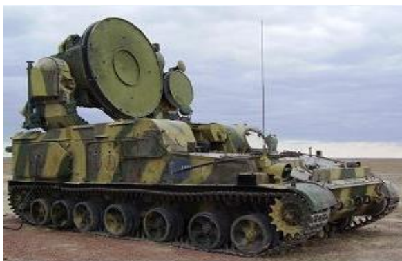
Рис. 1.25. Станция наведения ракет
