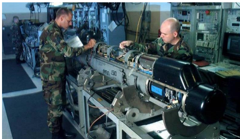
Рис. 2.32. Настройка аппаратуры постановки помех в подвесном самолетном контейнере
