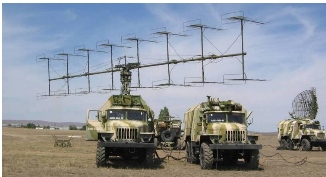
Рис. 3.4. Радиолокационная станция П-18
