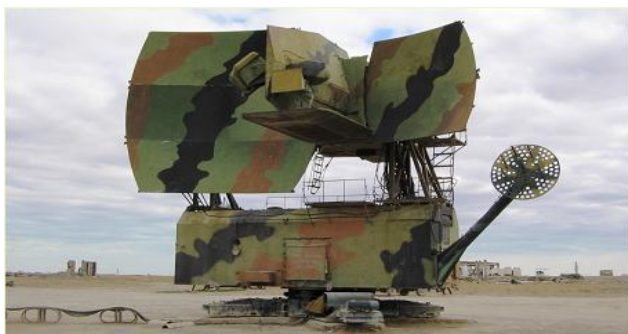
Рис. 1.21. Антенный пост с радиолокатором подсвета цели
