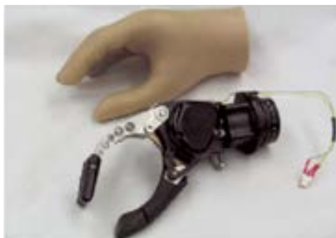
Рисунок 1.17 – Эксперимент Нейропротеза руки разработанный в университете штата Юта
