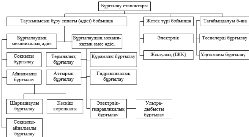
3.1 сурет. Ашық кен жұмыстарына арналған бұрғылау станоктарының жіктелімі
