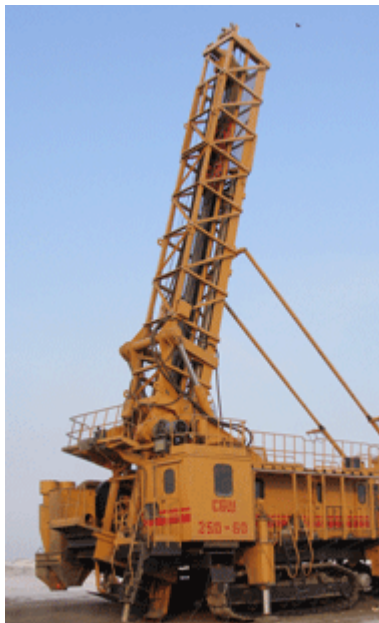
3.4-сурет. Шарқашаулы айналмалы бұрғылау станогы
