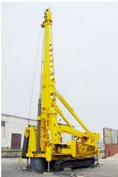
3.2-сурет. Соққылы-арқанды бұрғылау станогы
