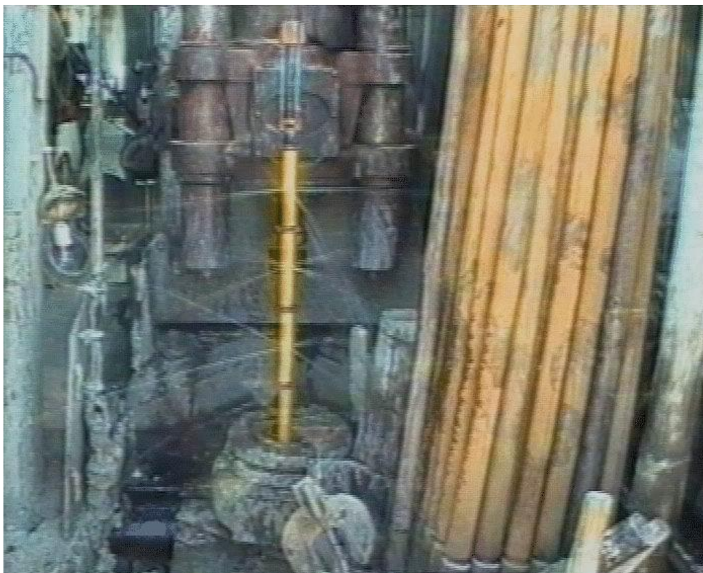
Рисунок 4.4 – Испытания гидровибрационного рабочего органа перед спуском в скважину
