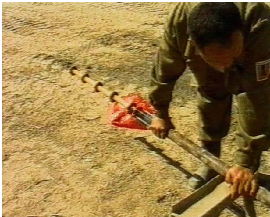
Рисунок 4.3 – Сборка гидровибрационного рабочего органа и его соединение с гидроударником Г59В
