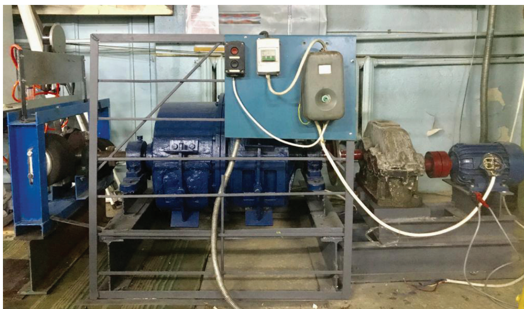
Рис. 4. Общий вид испытательного стенда шаровой мельницы, подключенной к ПВПУ
