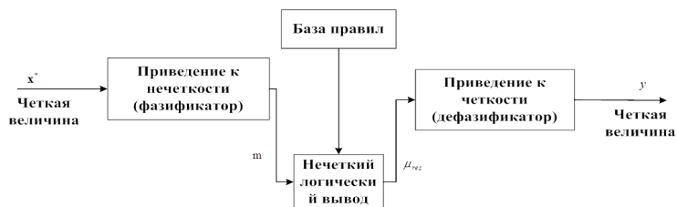
Рис. 17 – Процесс нечеткого вывода
