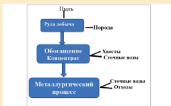
Рис. 1. Технологический путь поступления отходов в окружающую среду при добыче, обогащении и переработке руд.
