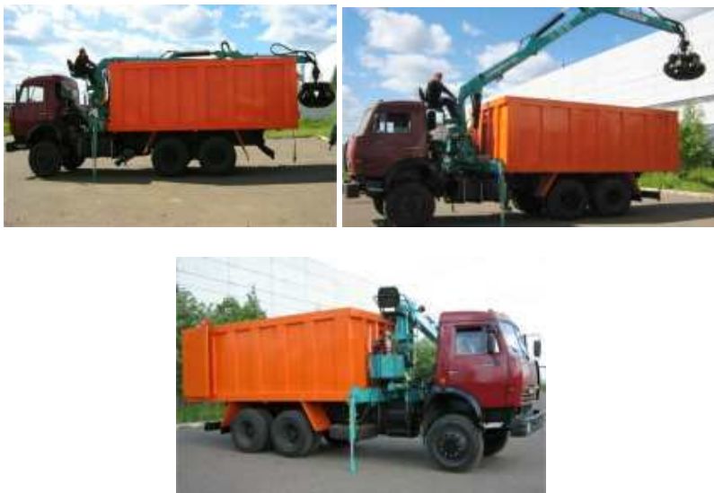
Рисунок 3.2. Ломовоз (металловоз) с крано - манипуляторной установкой на шасси автомобиля КАМАЗ-53229-1064 (65115)
