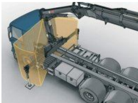
Рисунок 3.15. Система безопасности OPS компании Hiab
