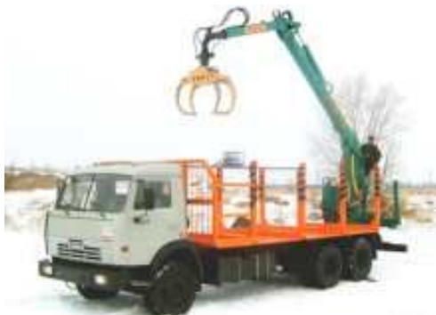
Рисунок 3.1. Сортиментовоз с краном-манипулятором на шасси автомобилей КАМАЗ 53229 (6х4), 53228 (6х6), 43118 (6х6)
