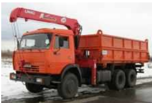
Рисунок 3.4. Автомобиль - самосвал КАМАЗ 65117 (6X4) с кран-манипуляторной установкой ИМ-150
