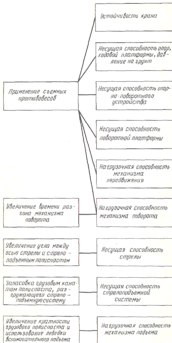
Рисунок 4.2. Схема влияния конструктивных изменений на факторы, определяющие возможную грузовую характеристику крана
