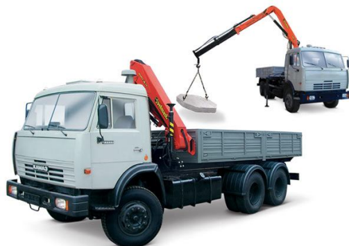
Рисунок 3.6 - Кран-манипулятор КМУ-90 на шасси автомобиля КАМАЗ 50205 с расположением за кабиной и поперечной схемой складывания
