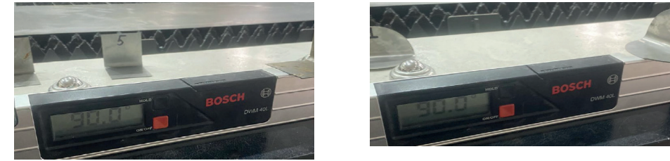
Рисунок 8 – Измерение угла заготовок с использованием оборудования для измерения угла после гибки: а) Заготовка размером 100x50 мм, толщиной 0,8 мм; б) Заготовка диаметром 81 мм, толщиной 1 мм
