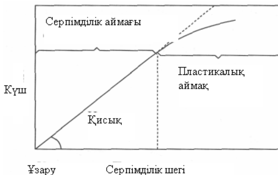
1.41-сурет. Серпімді эластикалық қасиеттерді көрсететін деформация қысымының тәуелділігі
