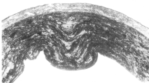
1.49-сурет. Бүгілген кезде қабат ажырауының микросуреті
