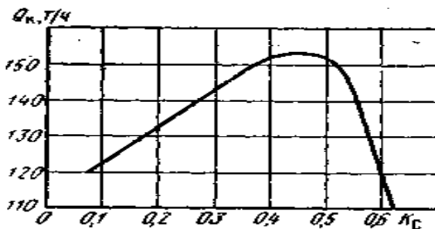
Рис. 4. Влияние коэффициента K_c на подготовленные к выемке запасы полезного ископаемого
