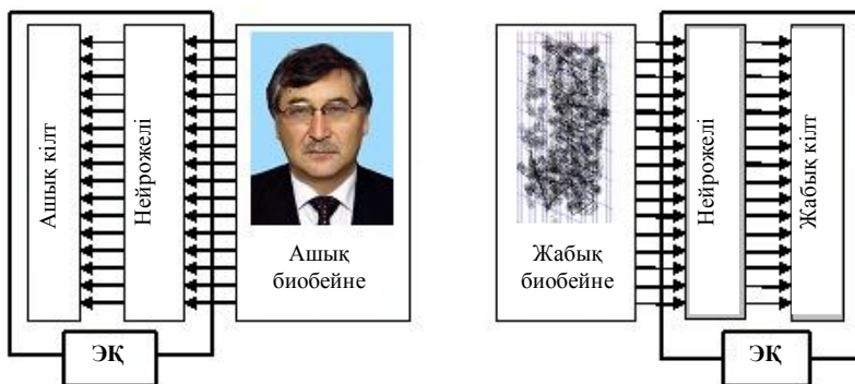
1.1-сурет. Қолданушының жеке басын биометриялық авторландыруды жүзеге асыратын автоматтарға арналған ашық және жабық электронды куәлік құрылымы
