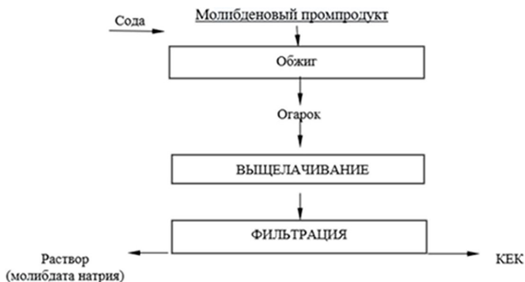
Рисунок 4 – Принципиальная технологическая схема получения молибдата натрия из молибденового промпродукта с применением обжига
