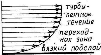
Рис. 7.3. Схема турбулентного потока жидкости
