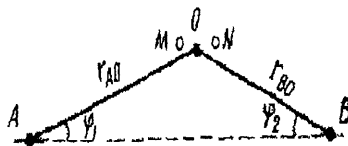
2.11-сурет. Орталық градиентпен түсіруге арналған қондырғы коэффициентін есептеуге түсініктеме
