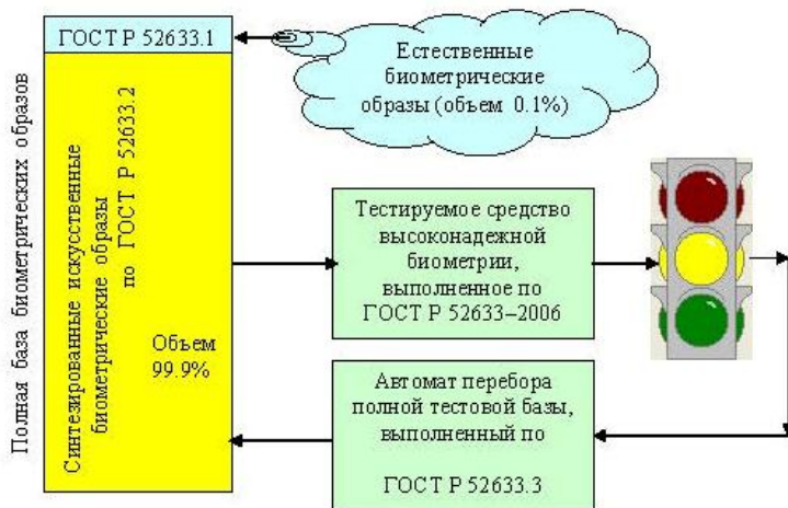
Рис. 5.2. Блок-схема тестирования по классической схеме перебора биометрических образов «Чужой» с хранением полной базы из миллиарда образов
