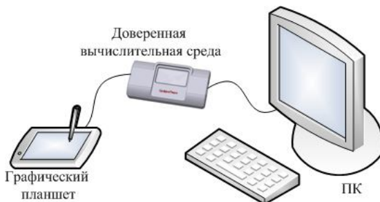
Рис. 2.14. Стык графического планшета с ДВС в виде USB Био-токена для безопасного формирования ЭЦП плательщика
