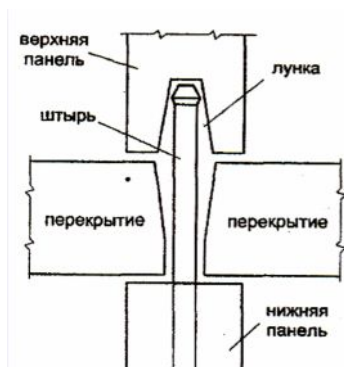
Рис. 31. Фиксатор для принудительной установки панелей
