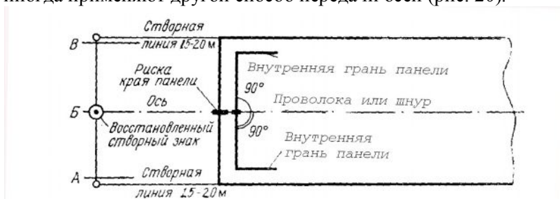
Рис. 20. Схема переноса осей на этажи с восстановлением створных точек
