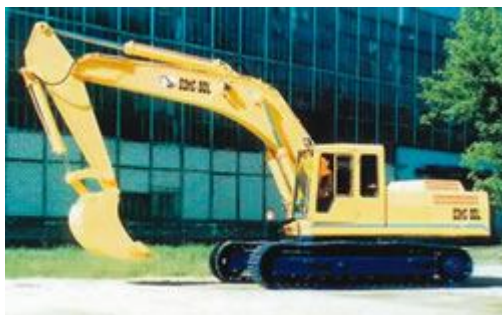
Рис. 4.18. Гусеничный экскаватор ЭО-5225
