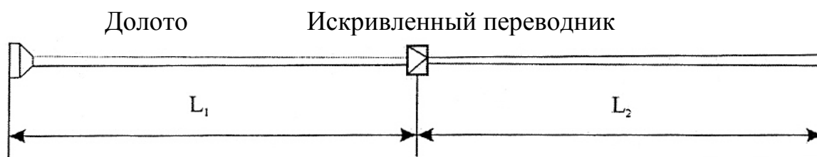
Рис. 5.16. Схема к расчету отклонителя
