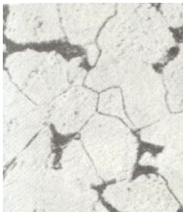
Рис. 7. Микроструктура углеродистой стали. X200 [3]
