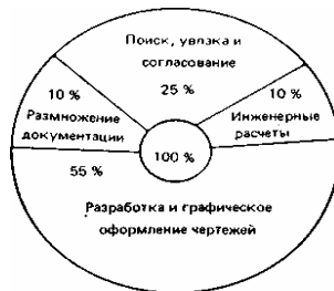
Рис. 11. Диаграмма распределения затрат труда при строительном проектировании
